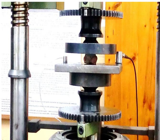
**Figura 2.** Ensayo de compresión. Máquina de ensayos universal AMSLER 6PZD 1406. Colocación del hueso al momento del ensayo con dos sensores de Emisión Acústica.
