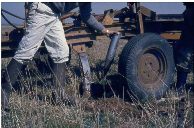
Figura 14. Subsolador con dren topo.
