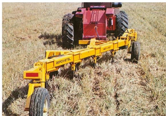
Figuras 12 y 13. Escarificado superficial del suelo: resultado de condiciones operativas adecuadas.
