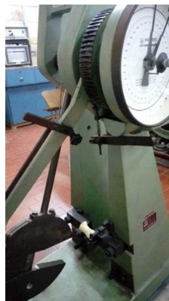
**Figura 2.** Máquina de ensayo de impacto modelo: PW 30/15 K-E. Fabricante Amsler-Wolpert.
